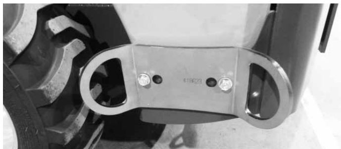
Suporte de conexão A418623 instalado na lateral da estrutura traseira. São necessários dois suportes para instalação lateral.
