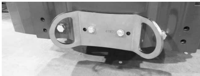
Suporte de conexão A418623 instalado no para-choques traseiro ou no contrapeso
